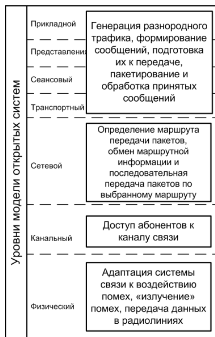
Рис. 3. Распределение агрегатов по уровням модели открытых систем.
