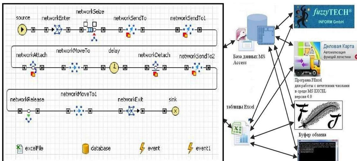
Рис. 2. Обмен данными между элементами имитационной модели
