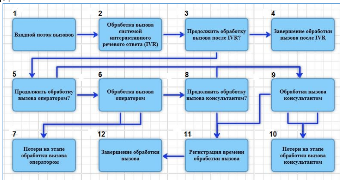
Рис. 6. Структурная схема модели КЦ
