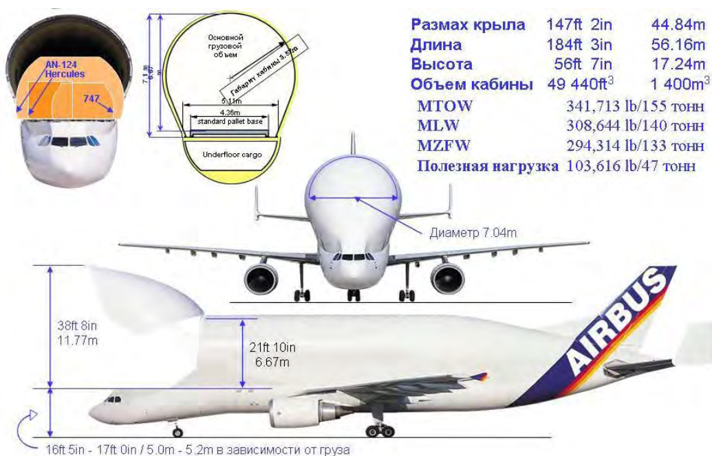
Рисунок 55 - Схема основного грузового объема и габарита грузового отсека самолета Airbus Beluga
