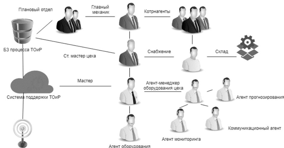
Рисунок 11 – Архитектура многоагентной системы поддержки ТОиР.
