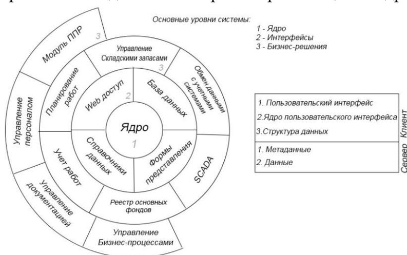
Рисунок 12 – Архитектура платформы быстрой разработки программных систем поддержки ТОиР оборудования.
