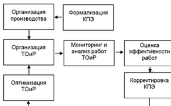
Рисунок 7 – Схема организации системы ТОиР на основе КПЭ.
