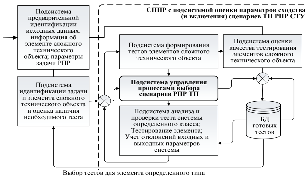
Рис. 5 – Укрупненная схема системы поддержки принятия решений (СППР) с подсистемой оценки параметров сходства сценариев ТП РПП СТУ
