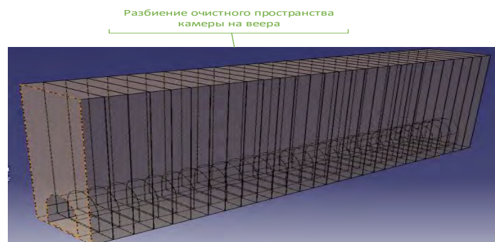
Рисунок 2.9 – Разбиение очистного пространства на веера
