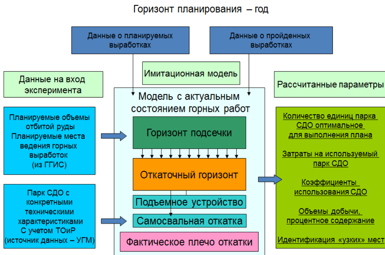
Рисунок 2.1 – Концептуальная схема системы имитационного моделирования, при горизонте планирования 1 год
