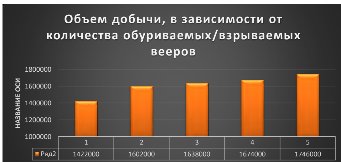
Рис.4.4 – Зависимость объема добычи от количества вееров
