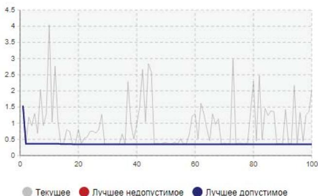
Рис.4 – Оптимизация исходной модели по времени нахождения товаров на конвейерах в системе AnyLogic
