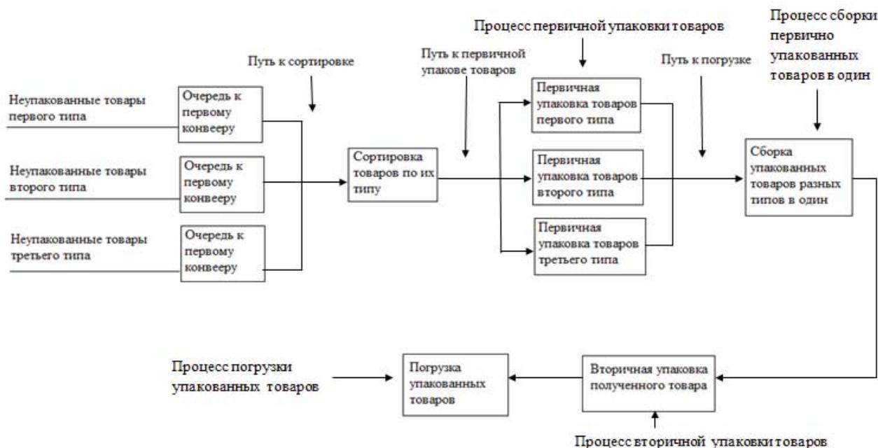
Рис.1. Структурная схема организации работы линии упаковки и погрузки товаров
