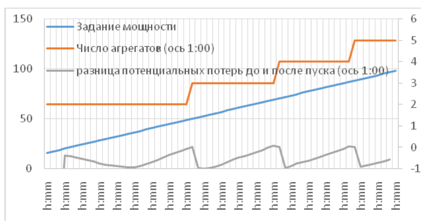
Рис.3 Оптимальное изменение состава агрегатов при росте загрузки
