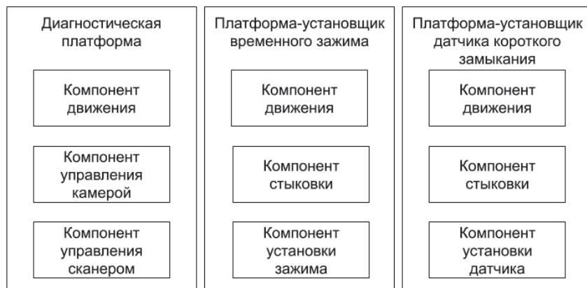
Рис.4. Конструирование платформ из различных компонентов
