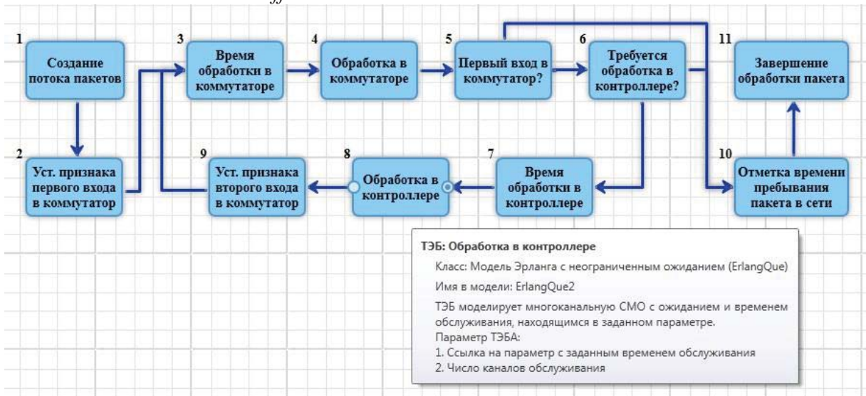
Рис. 2. Структурная схема модели ПКС OpenFlow
