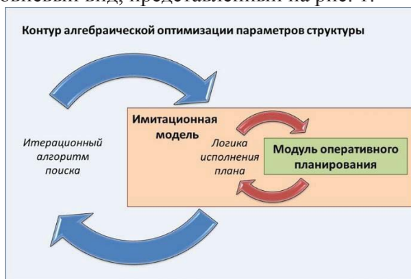
Рис. 1. Трехуровневая схема взаимодействия оптимизации и имитационного моделирования в задачах проектного анализа транспортно-технологических систем
