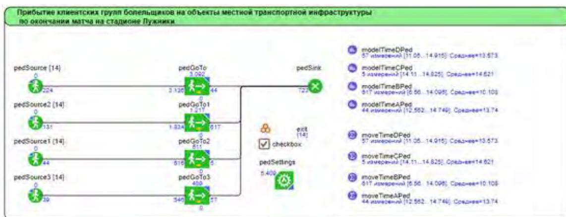
Рисунок 4.18 – Логическая структура работы имитационной модели №2.
