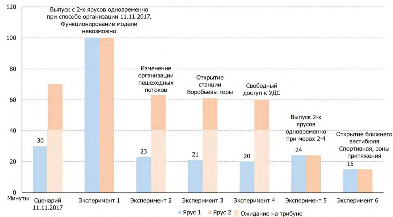
Рисунок 4.23 – График изменения значений времени в пути до станции «Спортивная».
