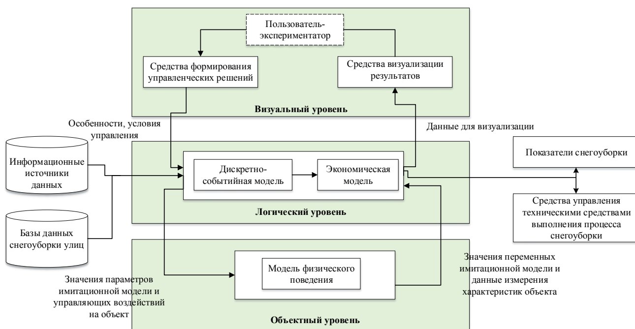
Рисунок 2.1 – Структурно-функциональная схема многоуровневых имитационных моделей процесса снегоуборки
