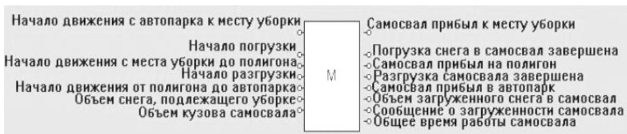
Рисунок 2.17 – Макрокомпонент «Самосвал» на логическом уровне
