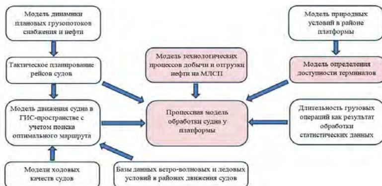
Рисунок 2 – Логические и функциональные блоки комплексной модели функционирования МЛСП и обслуживающего флота (цветом выделены блоки моделей, созданных автором)
