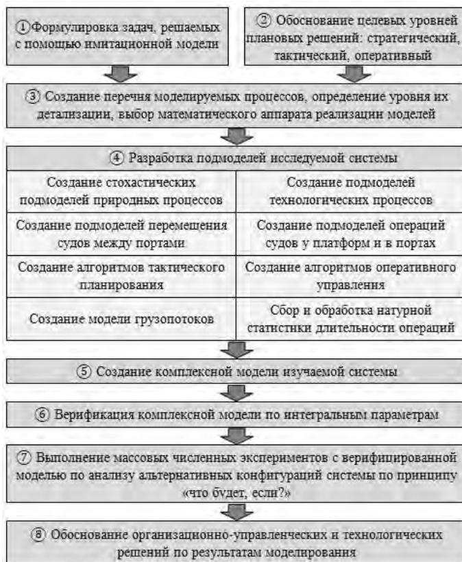
Рисунок 9 – Укрупненная блок-схема методики планирования работы флота обеспечения МЛСП с помощью имитационного моделирования
