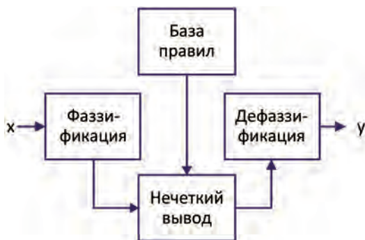
Рис. 4. Система нечеткого логического вывода [Кричевский и Серова, 2016]
