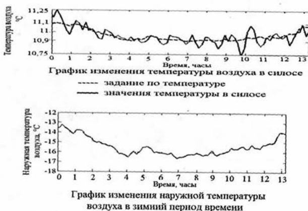
Рисунок 11. График изменения температуры воздуха внутри силоса, при возмущающем воздействии в виде изменяющейся наружной температуры.
