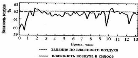
Рисунок 12. График изменения влажности воздуха в силосе при изменяющейся внутренней и наружной температуре.
