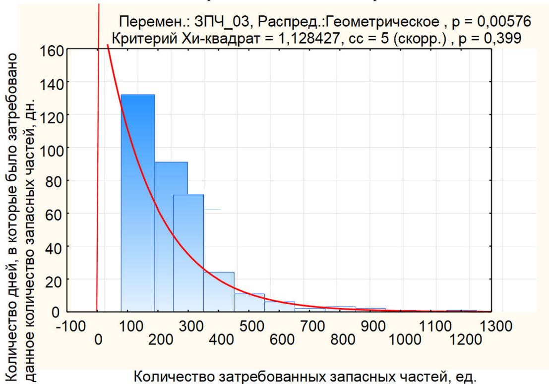
Рисунок 3 - Подгонка геометрического распределения запасной части масляный фильтр
