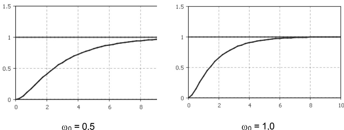
Рис. 5.18. Переходные процессы, биномиальная форма; система третьего порядка
