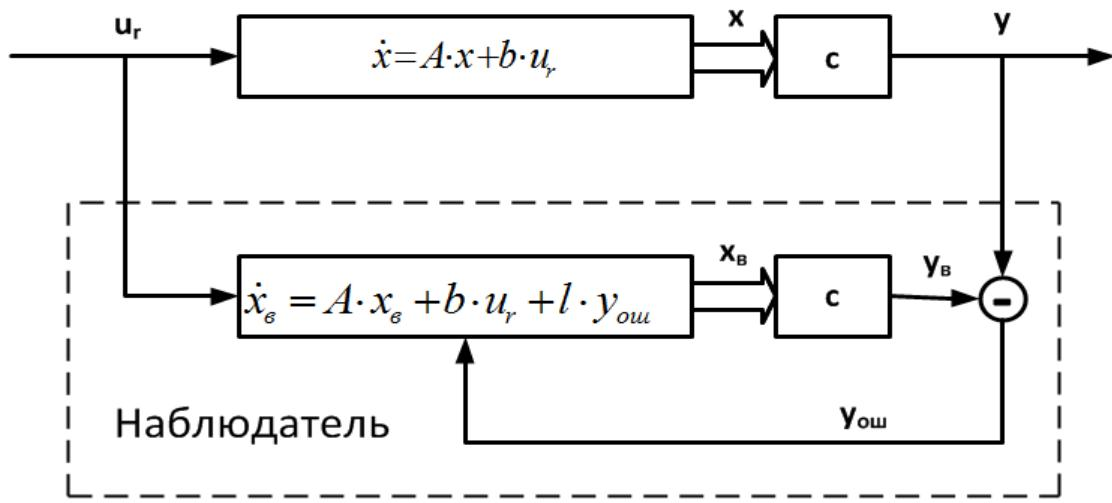
Рис. 5.13. Полный наблюдатель состояния:
