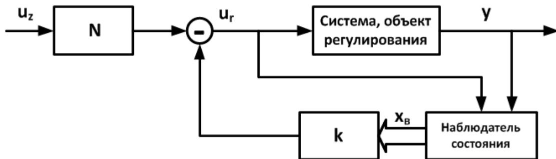
Рис. 5.14. Регулирование по восстановленному вектору состояния
