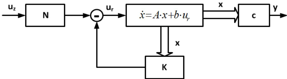
Рис. 5.12. Система с регулятором состояния:  $u_z$  – задающий сигнал;  $u_r$  – сигнал регулятора;  $K$  – вектор коэффициентов усиления регулятора;  $N$  – масштабный коэффициент усиления задающего сигнала
