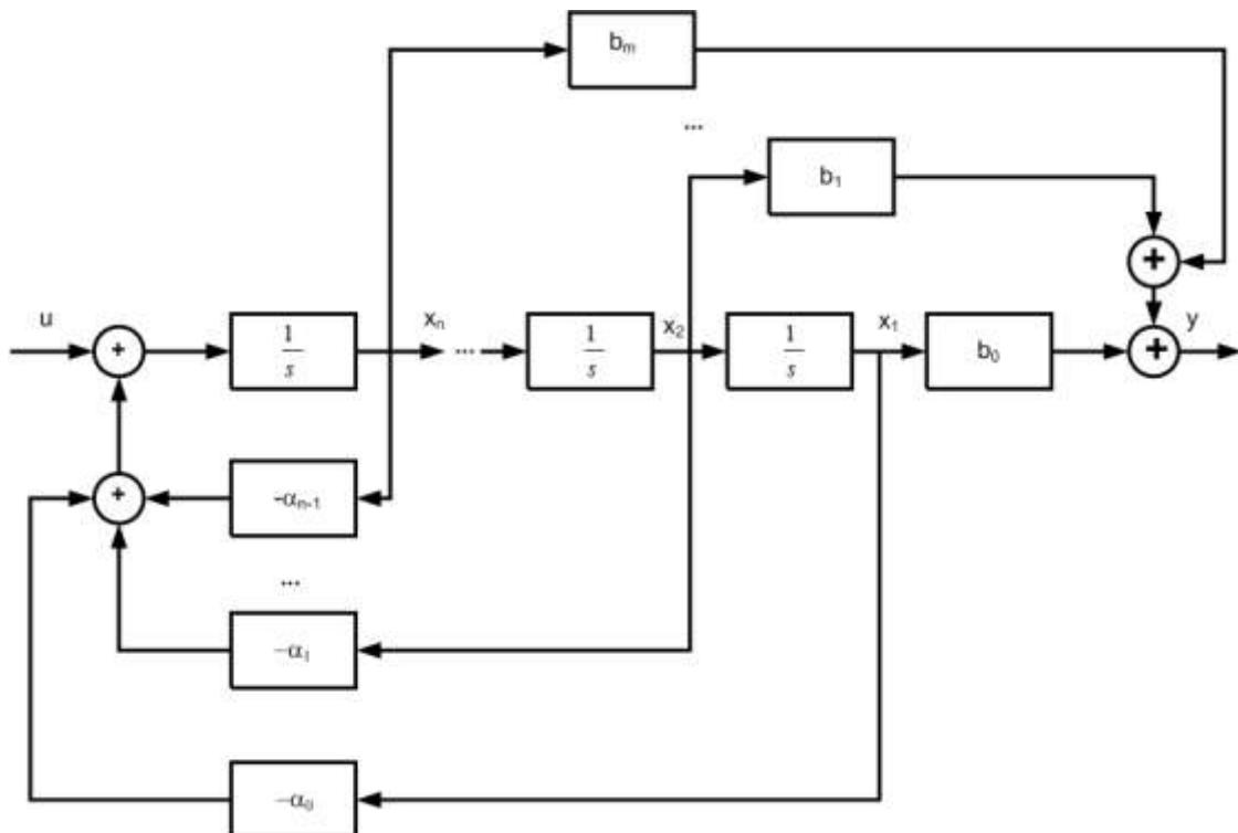
Рис. 5.15. Структурная схема системы с передаточной функцией при  $m < n$ ;
