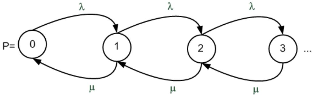
Рис. 4.5. Одноканальная СМО с бесконечной очередью
