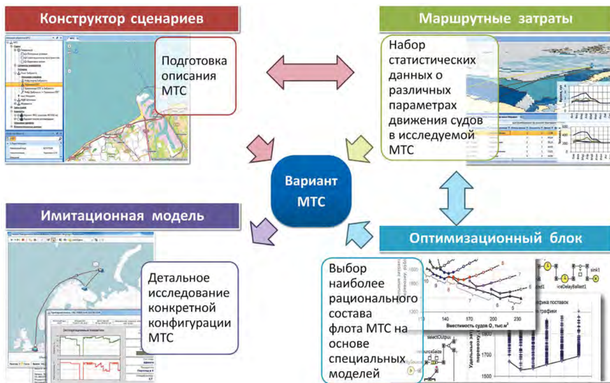
Рис. 4. Структурные блоки программного решения для исследования МТС
