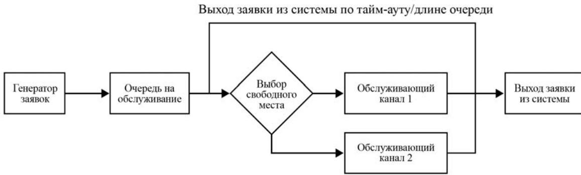
**Рис. 1.** Обобщенная структурная схема модели двухканальной СМО с ограниченным ожиданием
