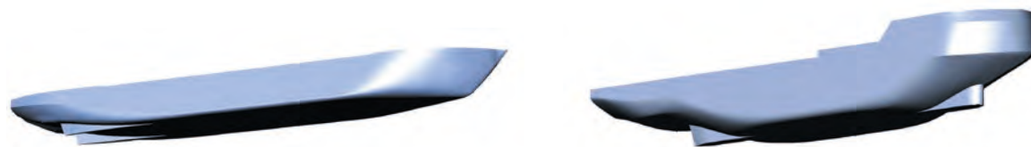
Рис. 6. Реконструкция обводов танкера (слева) и судна снабжения (справа)
