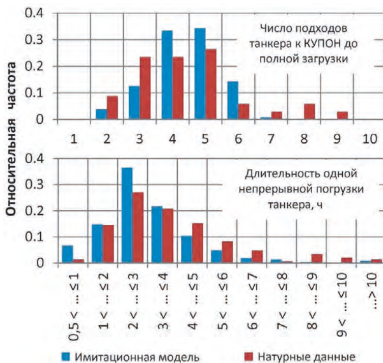
Рис. 12. Сопоставление натурных и модельных параметров работы танкеров
