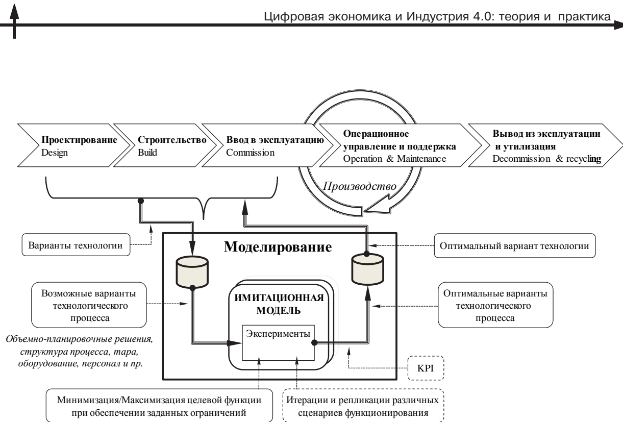
Рис. 4. Взаимосвязь между структурными элементами имитационных моделей и стадиями жизненного цикла производственного процесса
