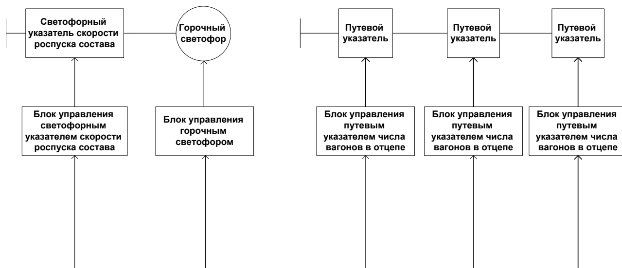
Рис. 3 - Участок управления горочным локомотивом
