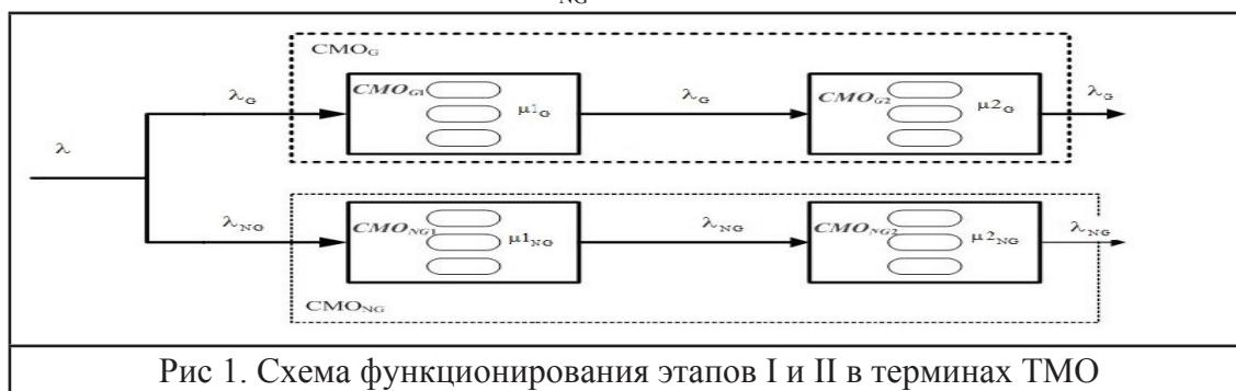
Рис 1. Схема функционирования этапов I и II в терминах ТМО
