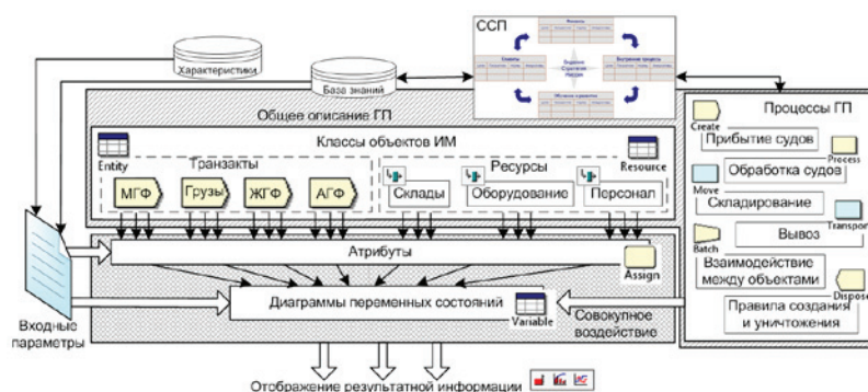
Рис. 2. Обобщенная структура ИМ в терминах SIMAN
