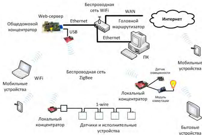
Рис. 1. Структурная схема системы «Умный дом»
