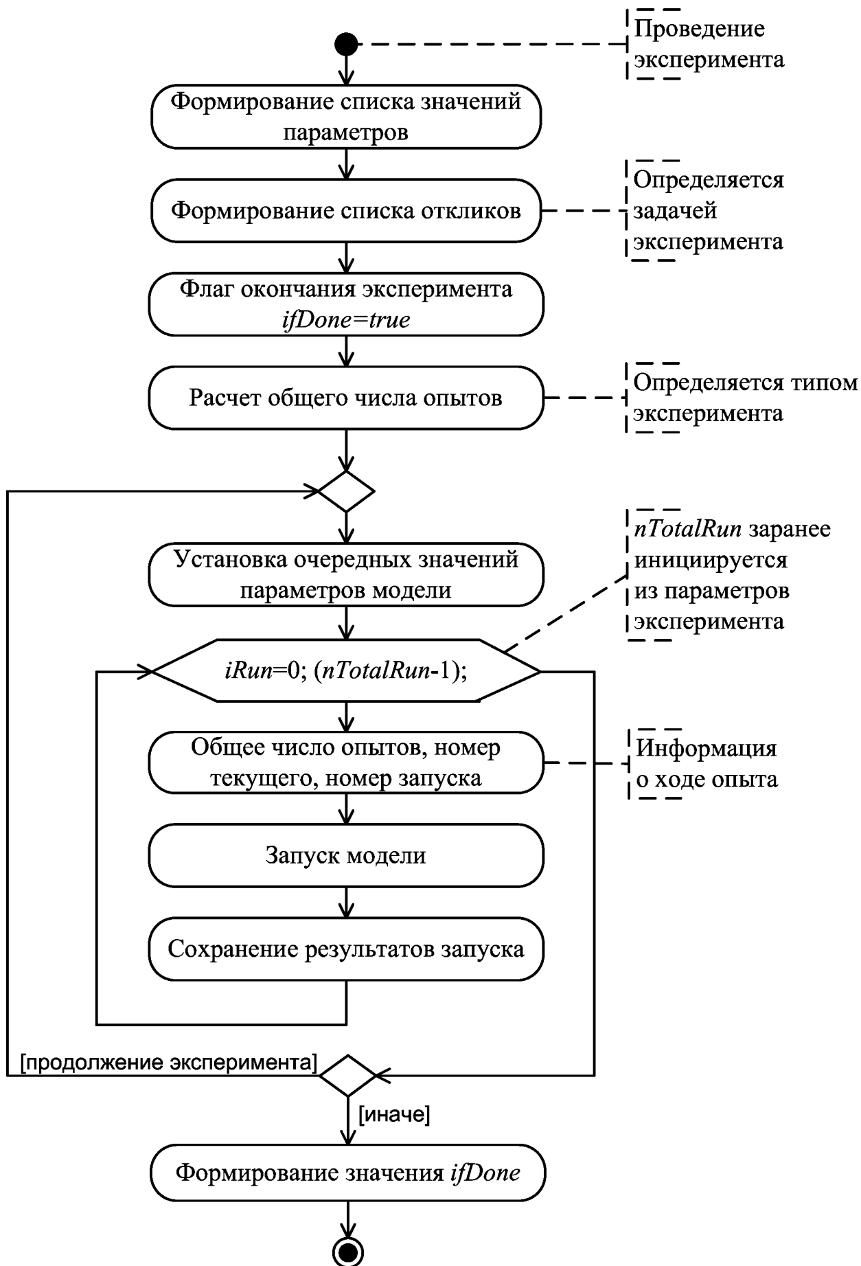
Рисунок 4.10 – Схема алгоритма блока проведения экспериментов
