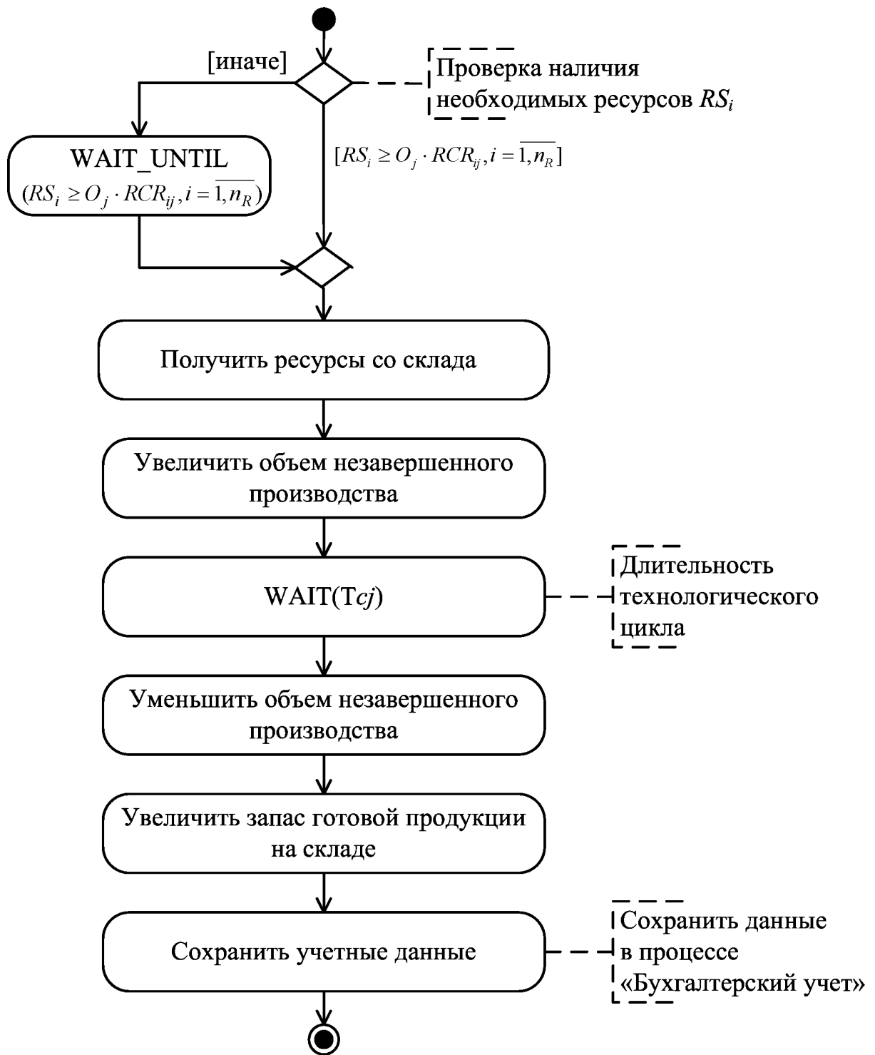
Рисунок Б.3 – UML-диаграмма процесса, имитирующего технологический процесс
