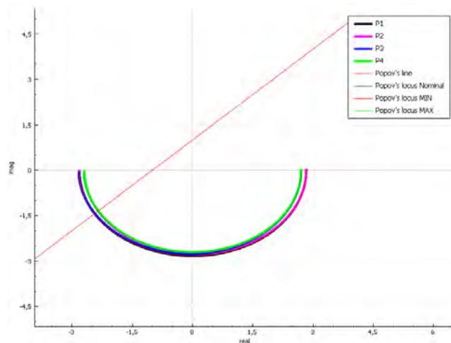
Рис. 1 - Модифицированные амплитудно-фазовые характеристики исследуемой системы.
