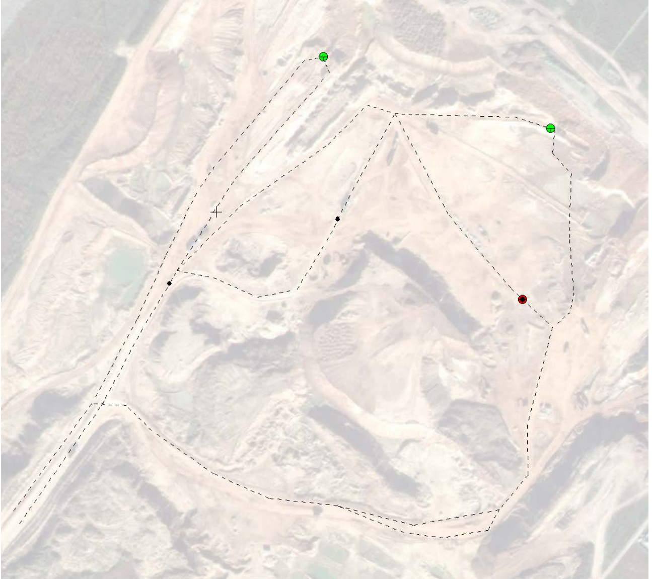
Рис. 18. Визуализация движения самосвалов в карьере
