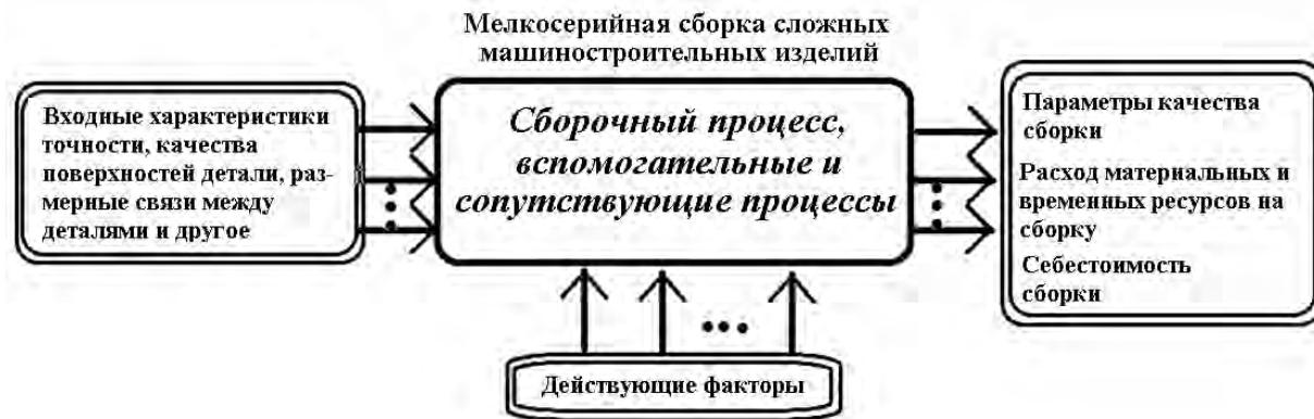
Рис. 5.8. Информационная схема технологической операции сборки изделия
