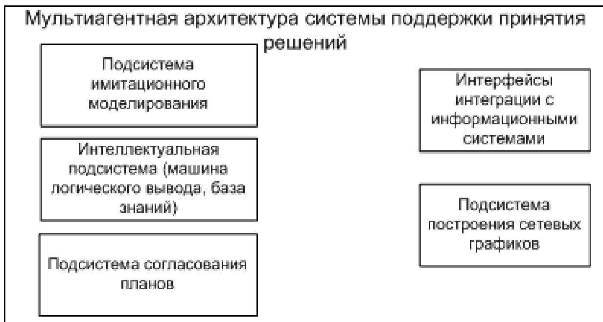
Рис. 4.21. Структура мультиагентной системы планирования
