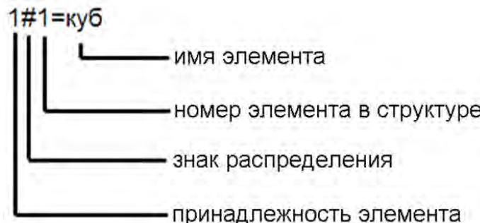
Рис. 5.19. Структура элемента в файловой системе
