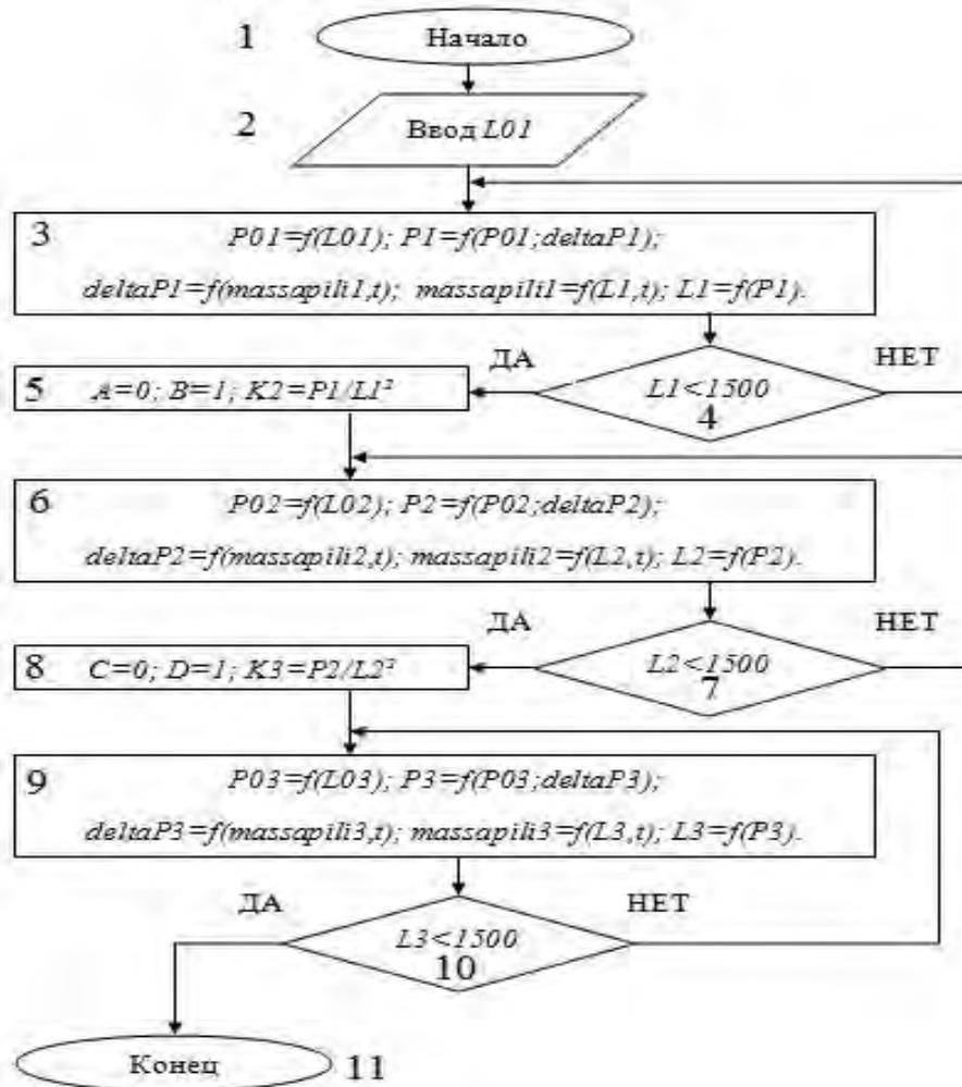
Рисунок 1 – Блок–схема программы расчета системы «вентилятор-фильтр»
