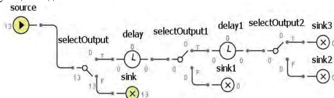
Рисунок 2 – Логическая цепочка рассматриваемых процессов в среде AnyLogic
