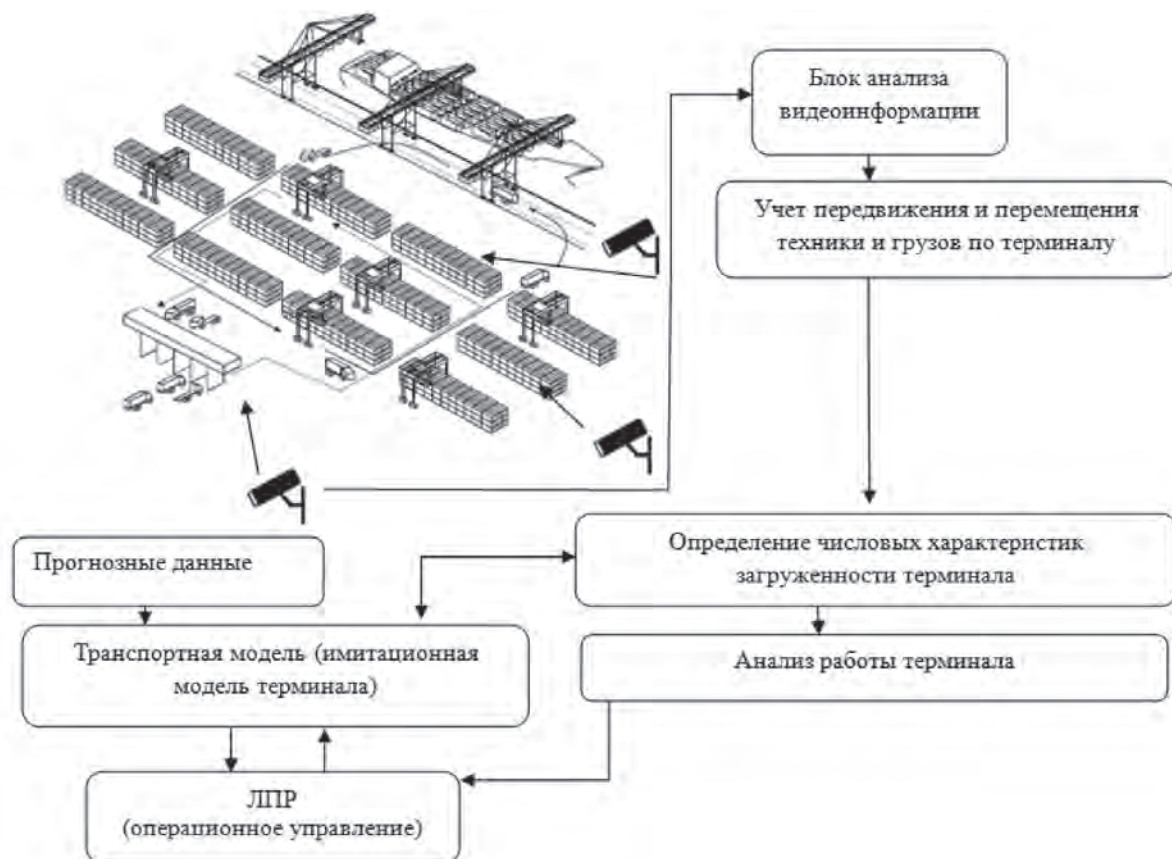
Рис. 4. Принципиальная схема использования транспортной модели на основе анализа видеoinформации с использованием имитационной модели контейнерного терминала
