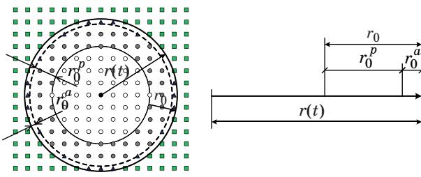
■ Рис. 4. Модель распространения критического сообщения в сети VANET с использованием предложенного алгоритма
