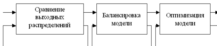
Рисунок 2.10 — Процесс калибровки имитационной модели
