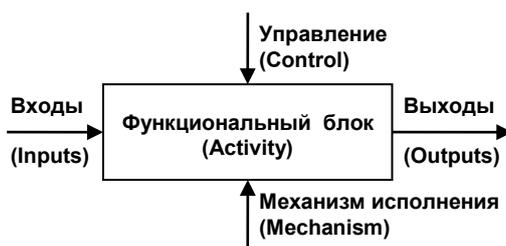
Рис. 1. Функциональный блок IDEF0
