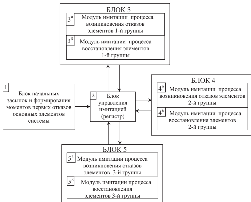
Рис. 2. Укрупненная блок-схема имитационной модели процесса изменения работоспособности элементов ТСИР
