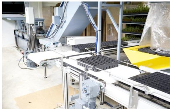
Рис. 5. Дополнительная линия подачи кассет на линию засева
