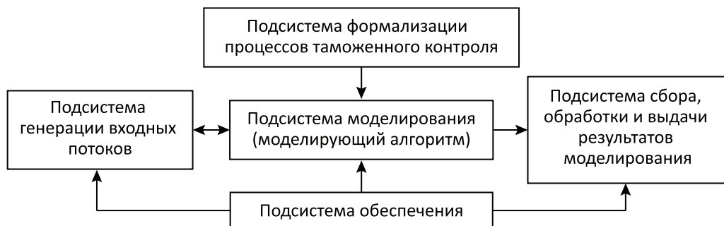
Рис. 3.1. Общая структура специализированной системы имитационного моделирования
