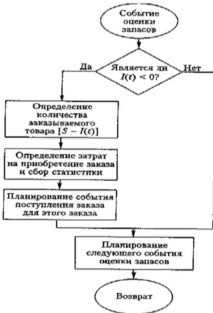
Блок-схема программы обработки события оценки запасов для модели системы управления запасами
