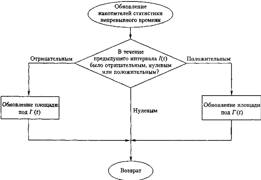
Рис. Блок-схема программы обновления накопителей статистики непрерывного времени для модели системы управления запасами
