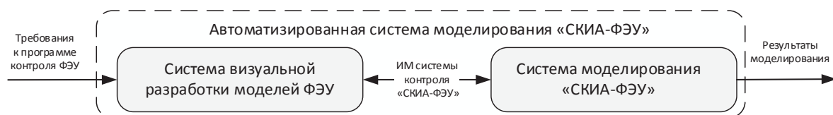
Рисунок 2 - Структура АСМ «СКИА-ФЭУ»
