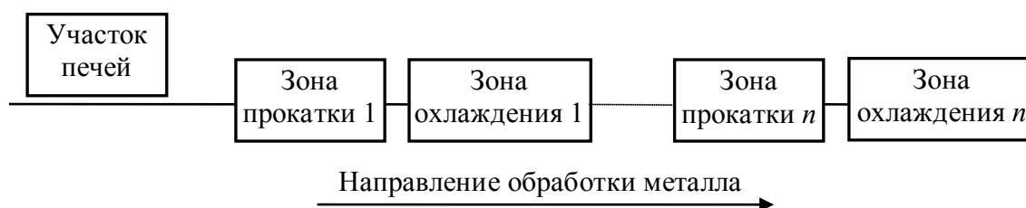
Рис. 1. Функциональная схема технологической линии стана 5000
