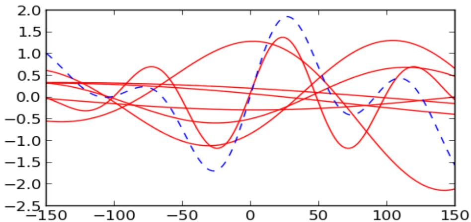
Рисунок 2: Аппроксимируемый вейвнетом сигнал (пунктирная линия) и выходы отдельных вейвлонов
