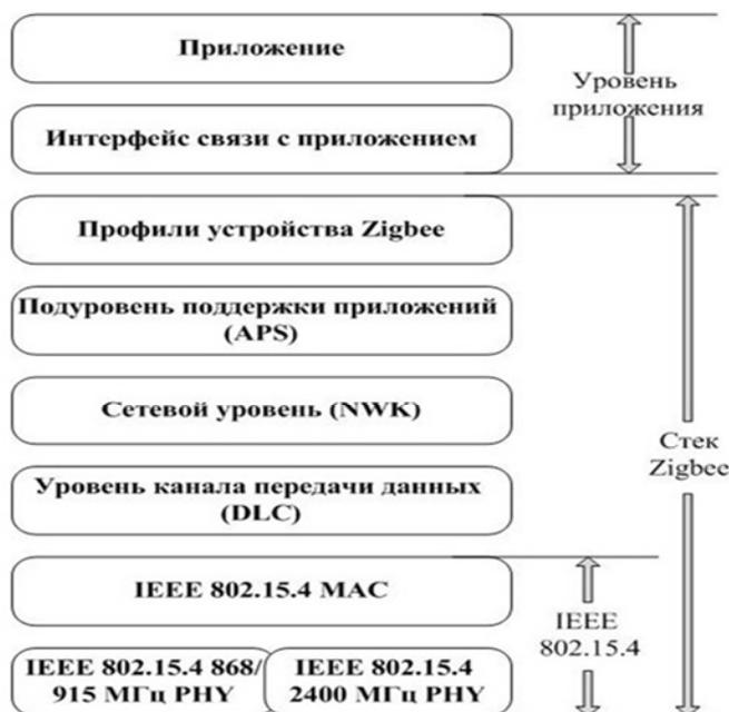
Рис. 3. Стек сетевых уровней Zigbee
