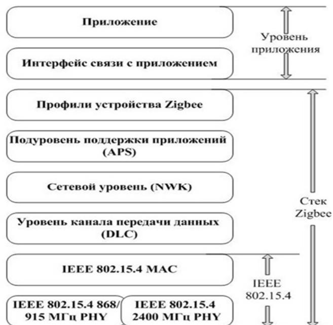
Рис. 3. Стек сетевых уровней Zigbee
