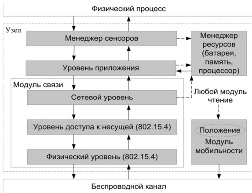
Рис. 4. Внутренняя структура узла БСС в Castalia
