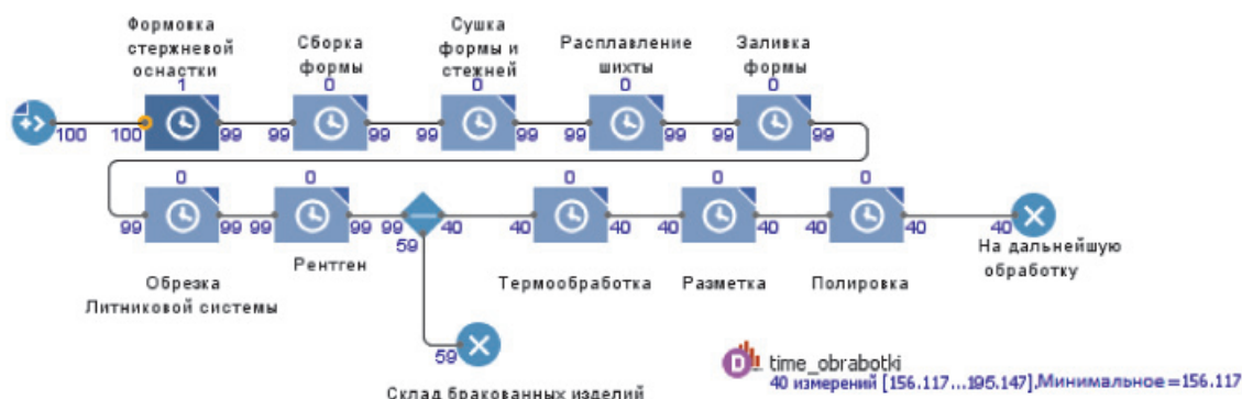
Рис. 2. Старый технологический маршрут изготовления «средней опоры»
