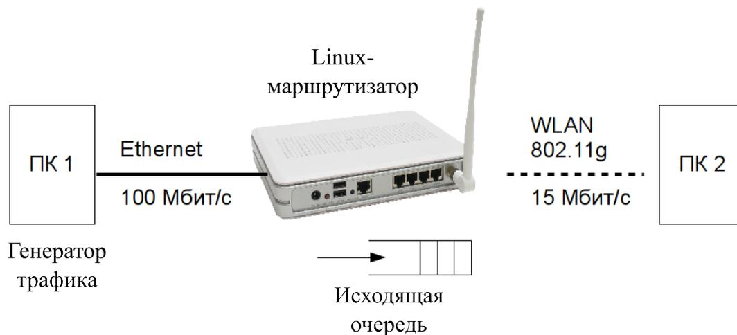
Рисунок 4.10 — Схема подключения маршрутизатора
