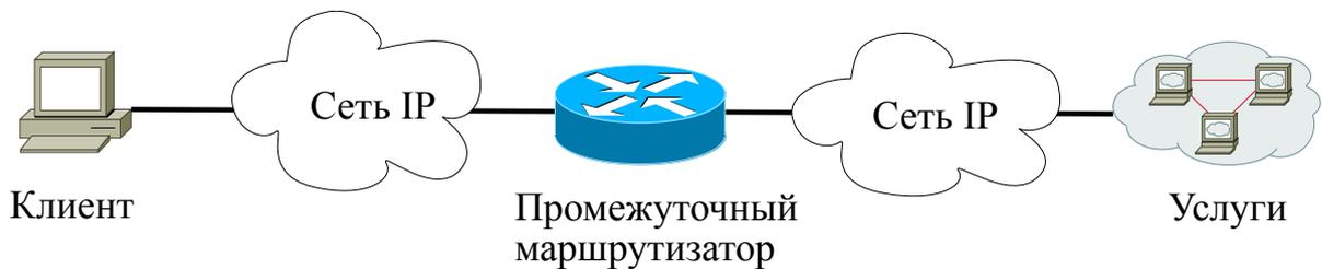
Рисунок 1.1 — Схема подключения промежуточного маршрутизатора
