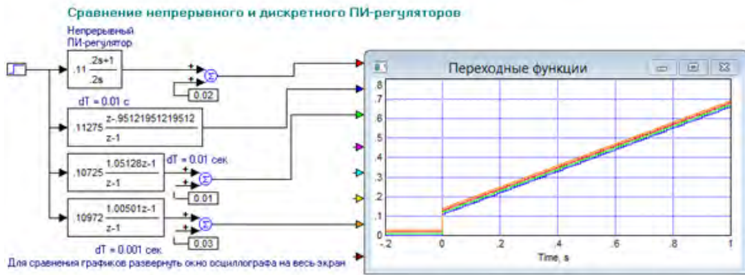
Рис. 8 – Відповідність цифрового ПІ-регулятора аналоговому
