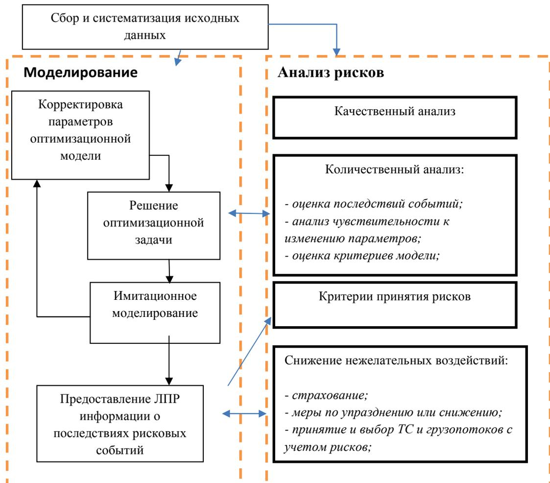
Рисунок 2.2 - Взаимодействие оптимизационной, имитационной моделей и методов анализа рисков.
