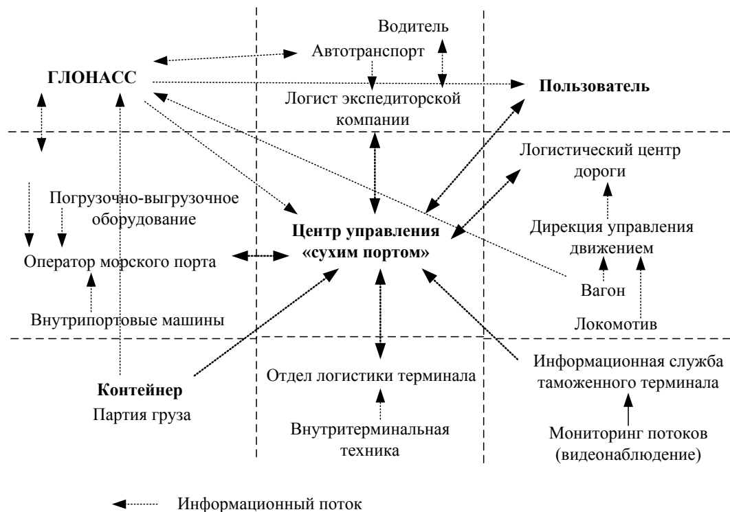
Рис. 4.2 Схема взаимодействия информационных систем в транспортном узле с единым центром управления «сухим портом»
