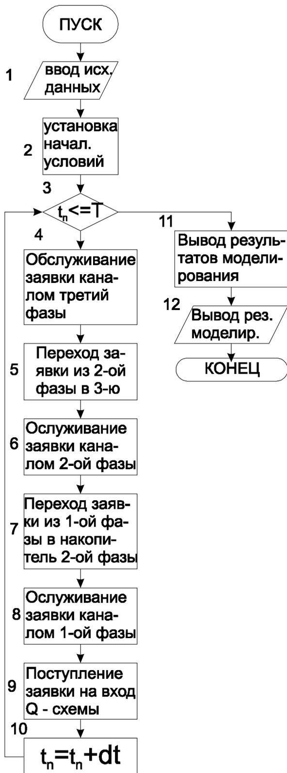
Рис. 8.5. Блок схема моделирования Q-схемы по принципу "Δt".
